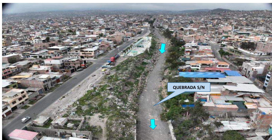
IMAGEN 03: EN ESTE TRAMO SE OBSERVA EN LA QUEBRADA S/N, SU CAUCE SE ENCUENTRA COLMATADO DE SEDIMENTOS, Y SIN PROTECCION EN AMBAS MÁRGENES; VISTA DE PLANTA MEDIANTE DRON.
